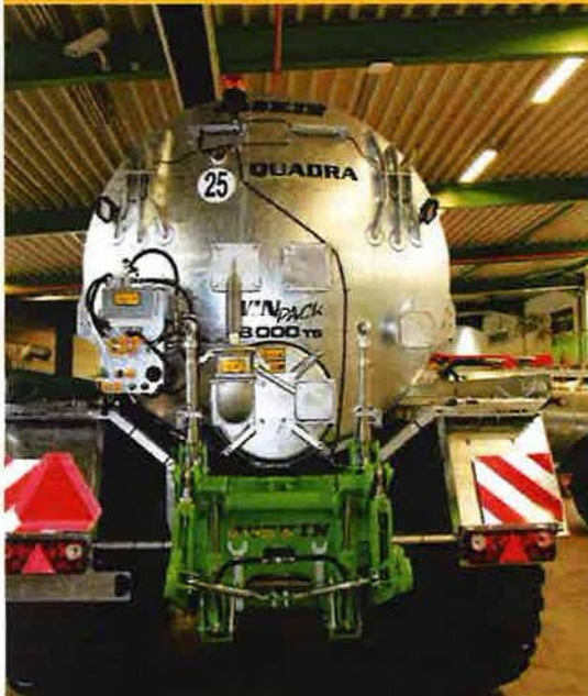
4х-точечный подъемник и крепления сверху цистерны представляют собой преоборудование для задненавесного орудия, как штанга с подвесными трубками.
