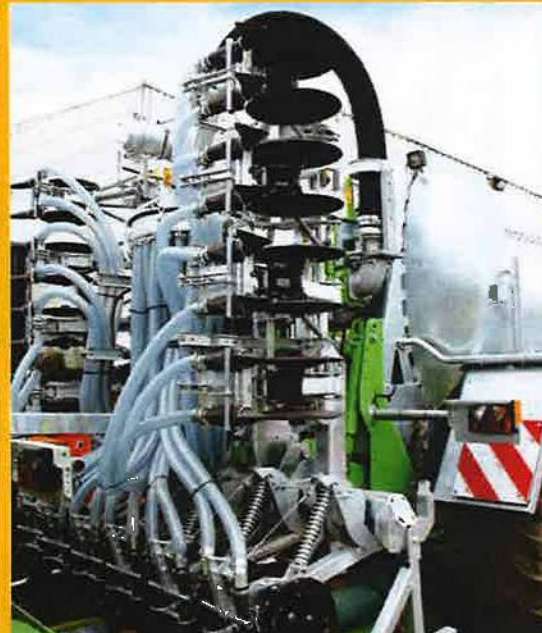
Modulo2 с инжектором silo-disc, готовые к отгрузке
